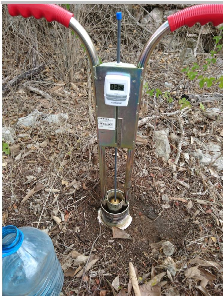
Figura 94. Punto de medición de infiltración en el SAR.
