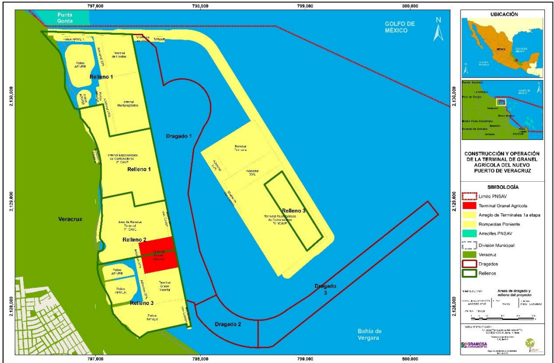
FIGURA 11 UBICACIÓN DEL DRAGADO Y RELLENO PARA LA TERMINAL DE GRANEL AGRÍCOLA EN EL CONTEXTO DE LA PRIMERA ETAPA DEL NUEVO PUERTO DE VERACRUZ.
