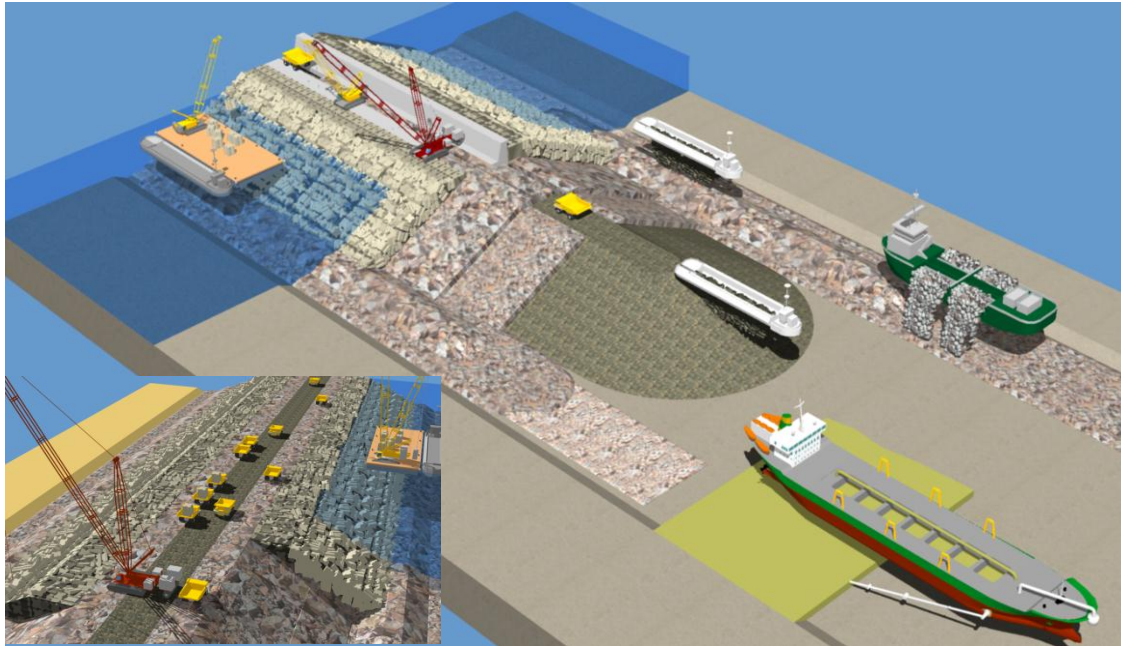
FIGURA 37 PROCESO GENERAL DE CONSTRUCCIÓN DE ROMPEOLAS
