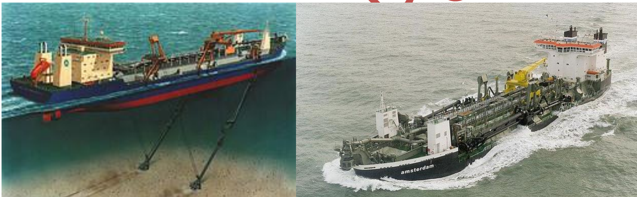
FIGURA 22 DRAGA AUTOPROPULSADA DE DOBLE RASTRA
