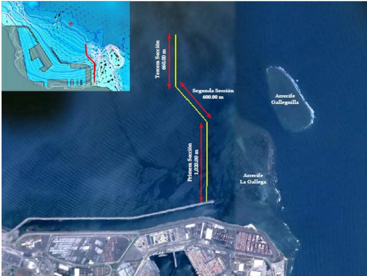
FIGURA 4 ARREGLO GENERAL DE MALLA ANTIDISPERSIÓN DE SEDIMENTOS
