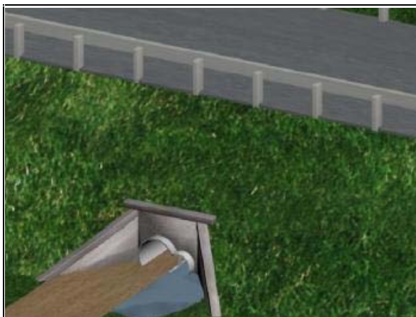
Figura 1.- Drenaje habilitado como paso inferior. Este tipo de paso permite tanto el desahogo del agua y permite el paso de la fauna
