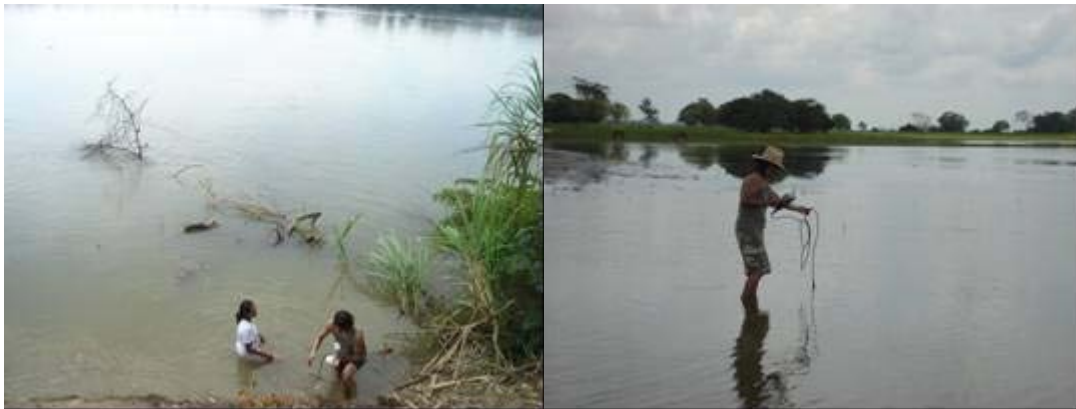
Fig. 1. Toma de parámetros fisicoquímicos en el río Samaria y en un humedal cercano a la Ciudad de Villahermosa. En la fig. Inferior se puede observar el uso del multiparamétrico de campo para medir Temperatura y Oxígeno disuelto entre otros.
