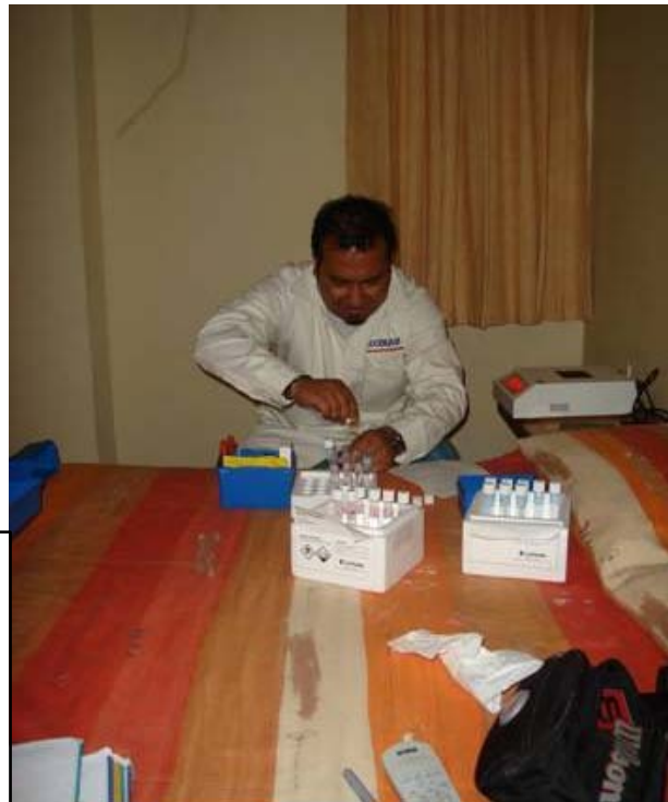
Fig. 14. Imagen del laboratorio que se montó en la salida de campo para hacer los análisis químicos. En la parte superior se pueden observar uno de los espectrofotómetros en los cuales se realizaron las medidas y el equipo de filtrado, en la imagen inferior se observa al QFB Victor Antonio Piñón Cabrera realizando una de las pruebas empleadas.
