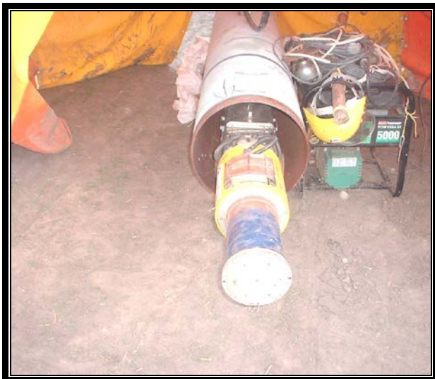
Equipo de radiografiado tipo crawler (interior).
