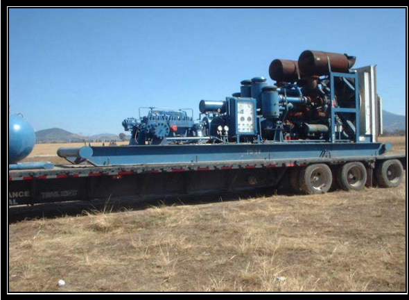
Equipo para hacer descender temperatura de aire inyectado para envío de esponjas y cepillos.
