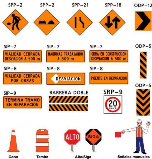
Figura 2. Señalizaciones en las obras.
