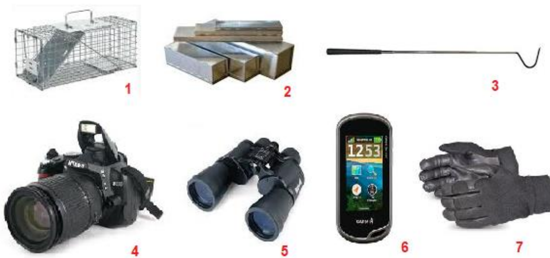
Imagen IV. 53. Equipo utilizado para el muestreo de fauna. 1) Trampa tipo Tomahawk 2) Trampa tipo Sherman 3) Gancho herpetológico 4) Cámara Réflex 5) Binoculares 6) GPS 7) Guantes
