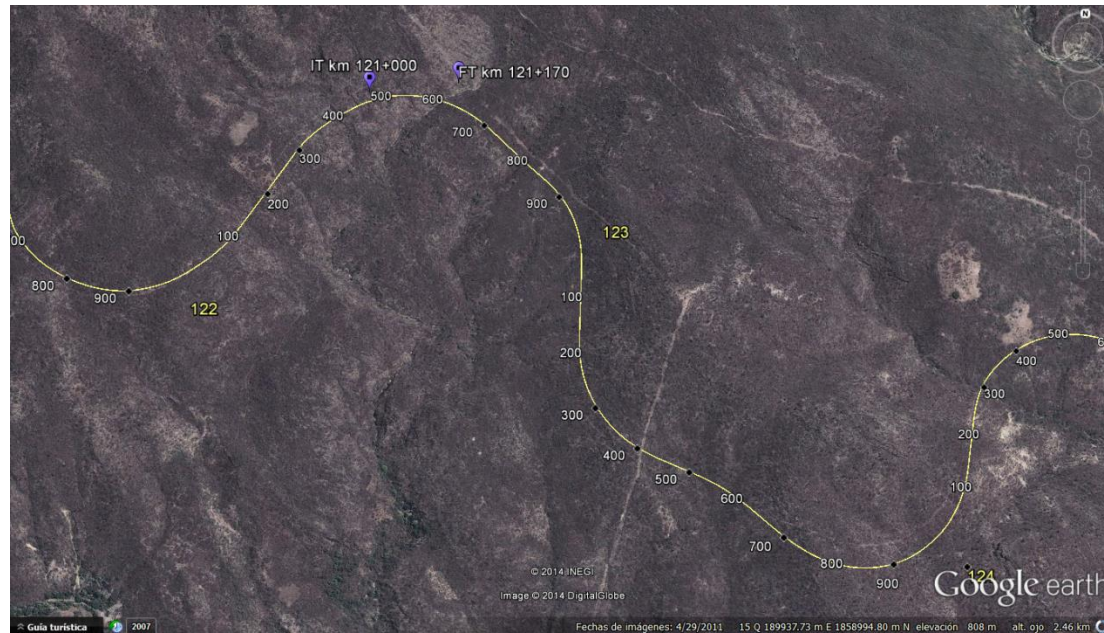
Imagen VII.33 Ubicación del túnel km 121+000 – km 121+170
