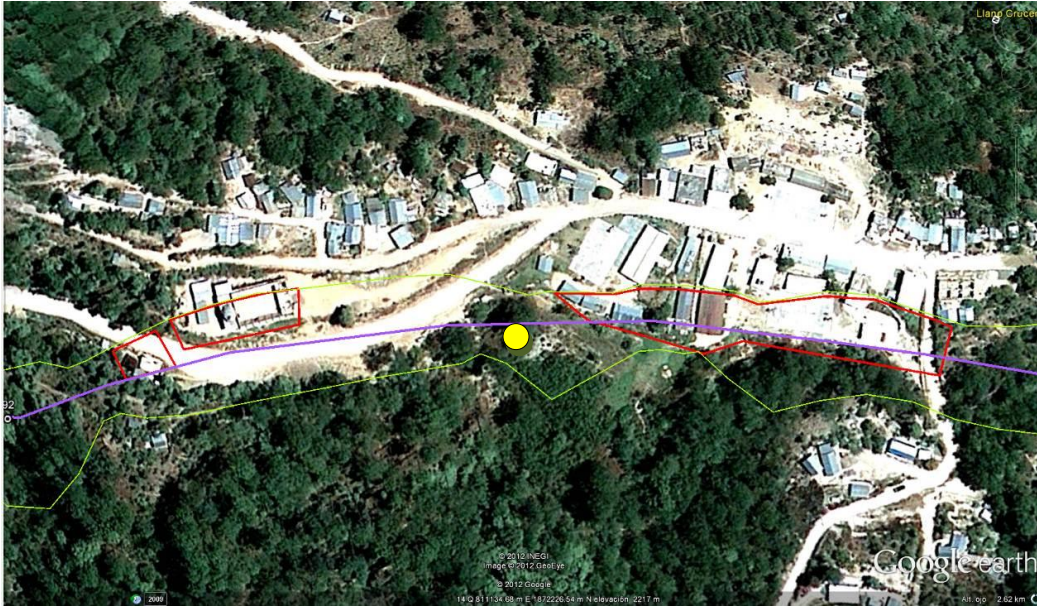
Imagen IV.85 Cadenamiento 92+100 aprox. En color rojo se muestran algunos polígonos dentro del Área de la línea de ceros (línea verde) donde se ubican casas e inmobiliario que será afectado en la realización de la obra. El círculo amarillo muestra la ubicación de donde se tomó la siguiente fotografía.
