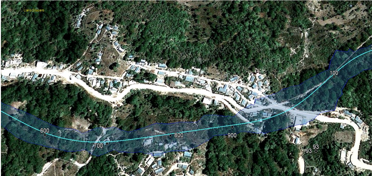
Imagen IV.87 Cadenamiento del 92+600 al 93+000 aprox. Se observa el área de la línea de ceros en azul donde se observa la afectación a estructuras dentro de la comunidad Llano Crucero.
