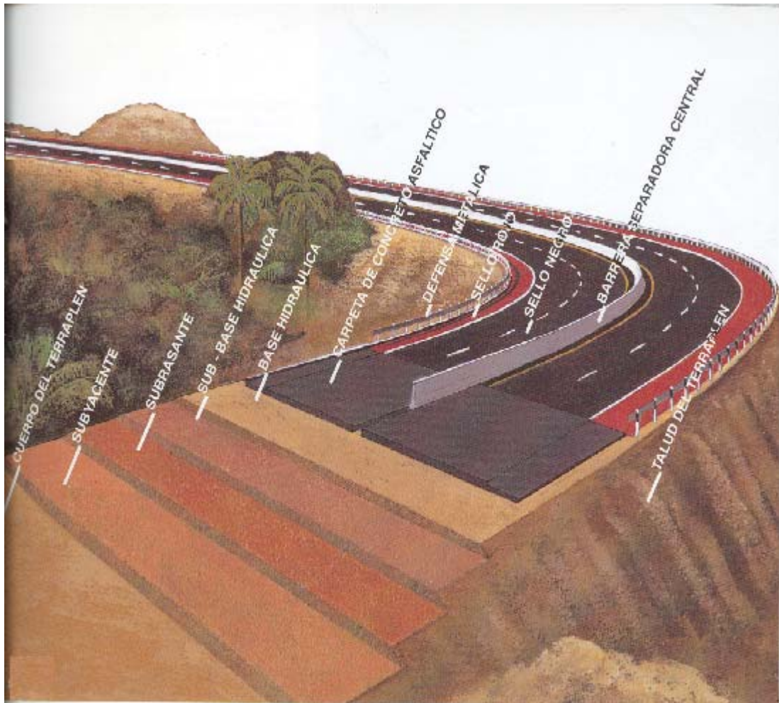
Sección típica de un terraplén
