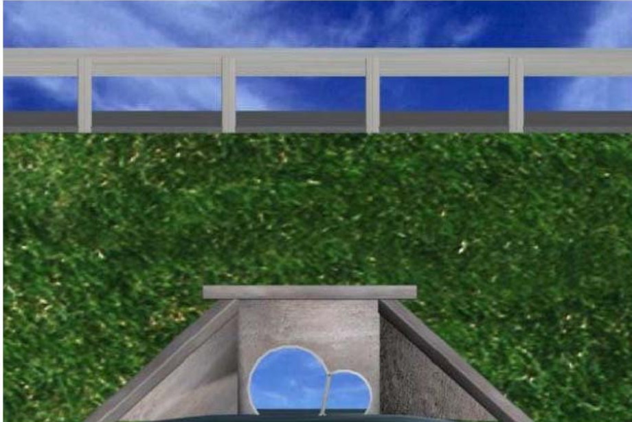
Figura 7. Esquema de un paso inferior de fauna silvestre con dos tubos.
