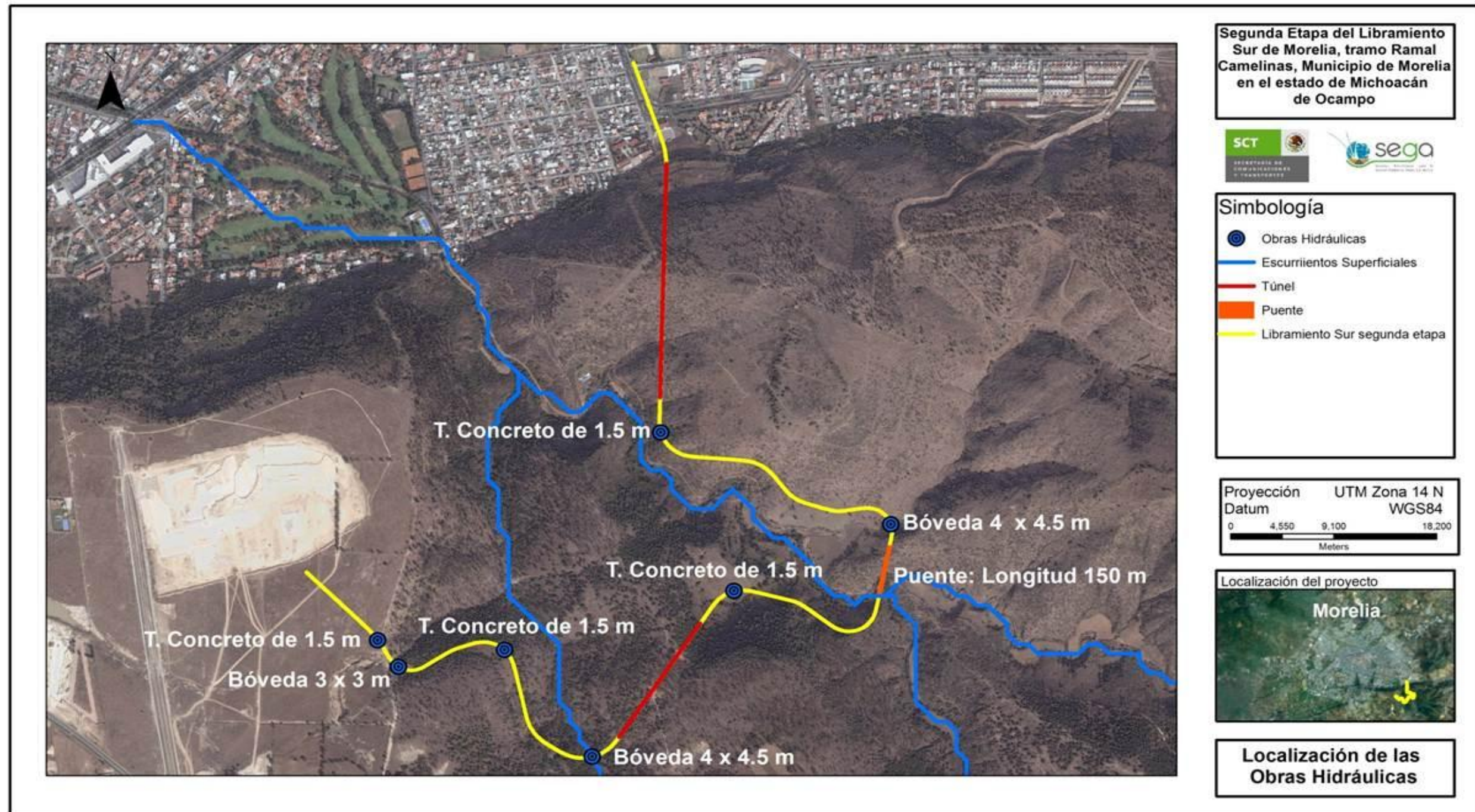
Figura 19. Localización de las obras hidráulicas.
