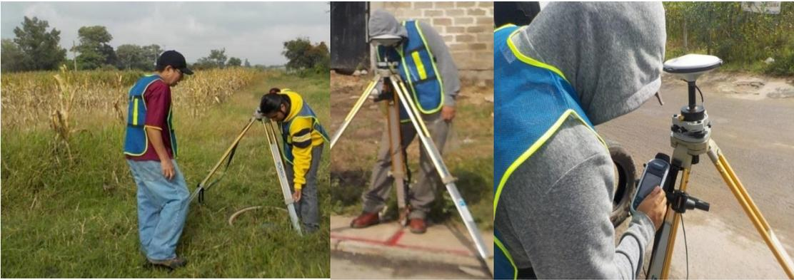
Fotografías de nivelación y configuración de la antena base.
