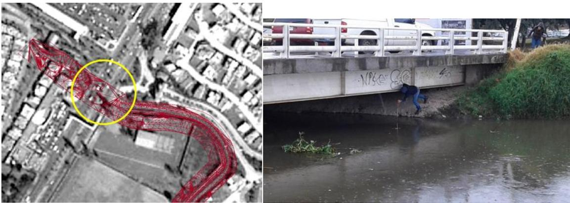
*Figura VIII-10. Medición de profundidad en puente.*
