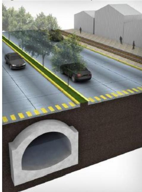
*Figura II-6. Colectores construidos en el sitio*
