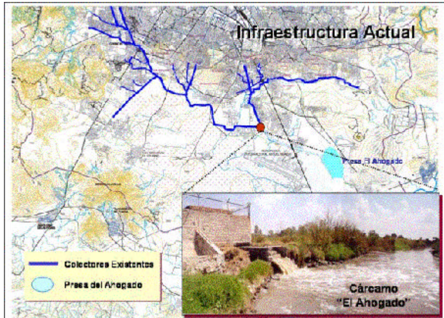
Figura 11 : Colectores existentes que alimenta la presa del Ahogado
