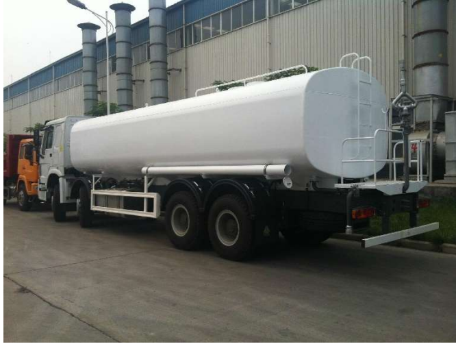
16. Figura II.26. Camión transportando agua con una capacidad de 20m 3
