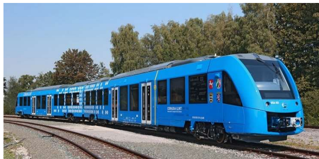
Figura II.4. Tren de hidrógeno Coradia iLint en Alemania
