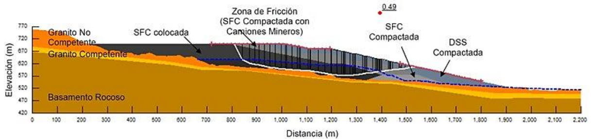
Figura IV. 31 Resultados de los Análisis de Estabilidad de Taludes – Condición Pseudoestática.
