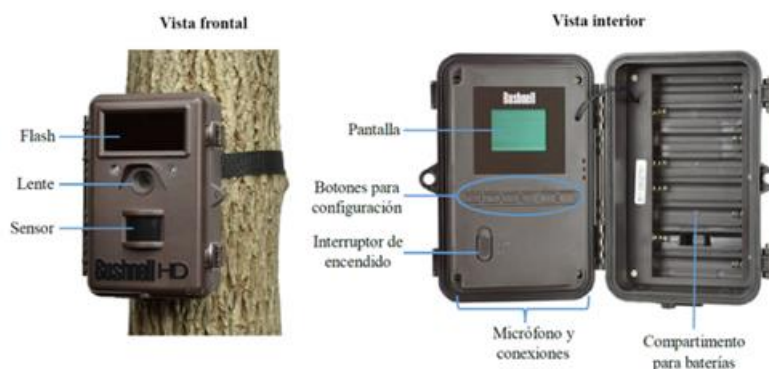
Figura 34. Partes y botones para ajustes de la fototrampa
