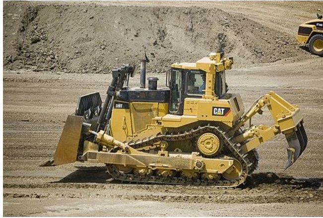
Figura 6. Imagen representativa de un bulldozer para el despalme.
