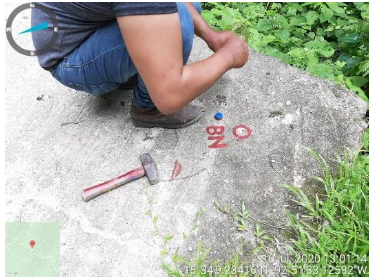
Figura 15. Puntos de referencia para el levantamiento topográfico
