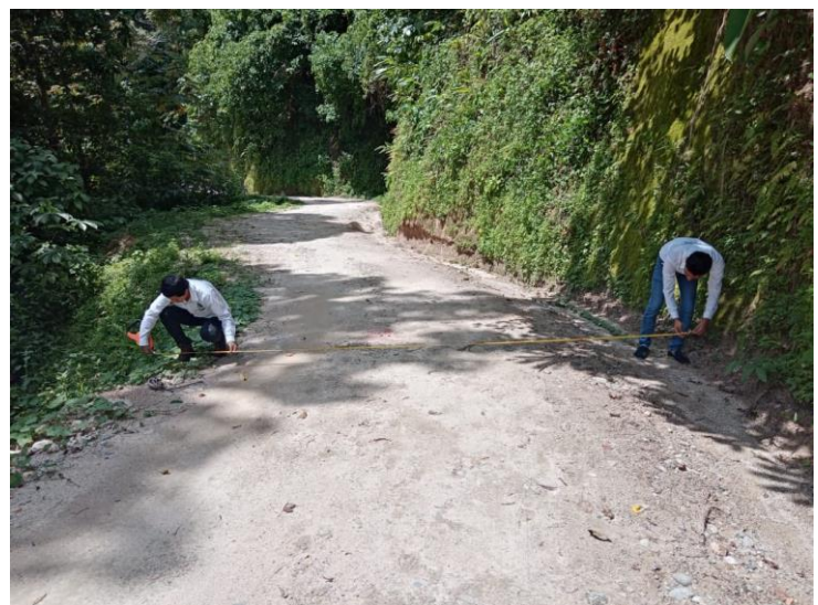
Figura 3. Medición del ancho de corona del camino
