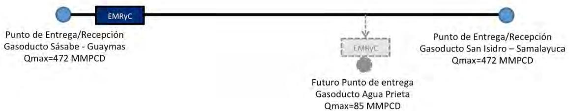
**Figura II.4** Diagrama general del Sistema de Transporte de Gas Natural.
