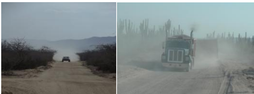
Figura IV.31. Generación de partículas suspendidas por el tránsito de vehículos por vías no pavimentadas.
