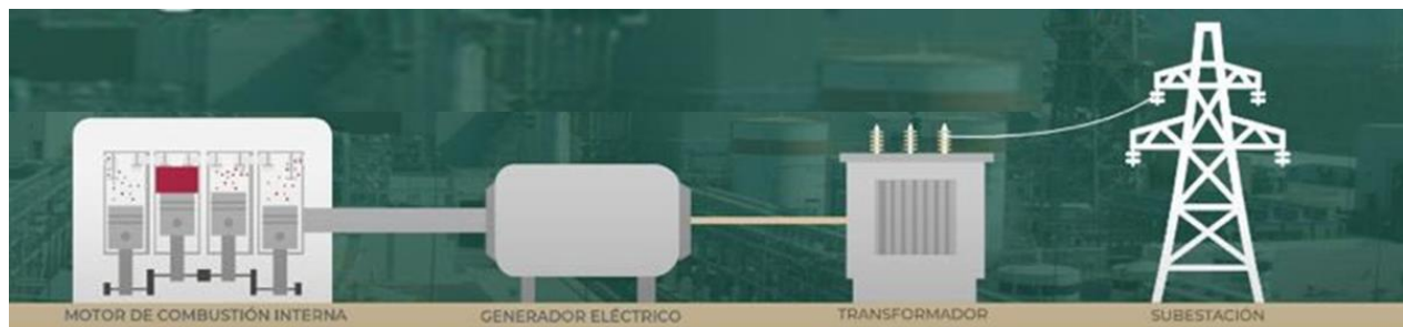
Figura II.16. Diagrama general de funcionamiento de una central de combustión interna
