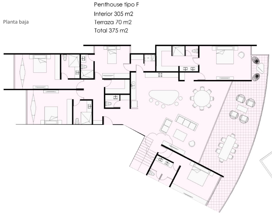
FIGURA II.56. PLANTA BAJA PENTHOUSE TIPO F
