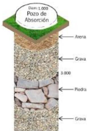
**Ilustración 9. Composición y distribución de capas de relleno del pozo de absorción. Se recomienda utilizar piedra porosa o tezontle de tamaño de 0.07 a 0.10 m, grava de granulometría variable comprendida entre 20 y 50 mm, y arena lavada gruesa que pase 100% la malla número 4, con un tamaño efectivo de 0,30 a 0,60 mm.**
