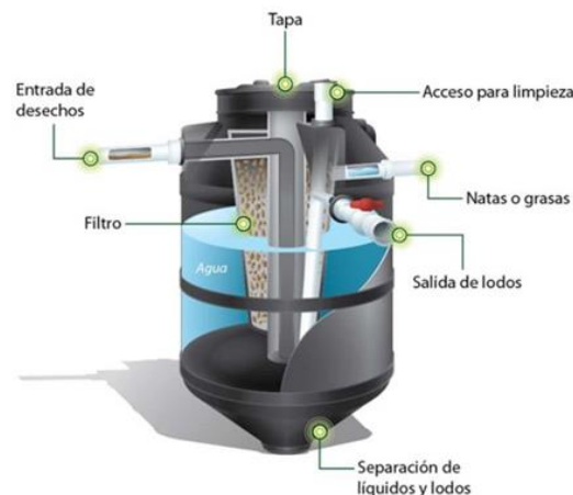
Figura II.14.- Esquema de los componentes del biodigestor propuesto para el manejo de las aguas residuales.
