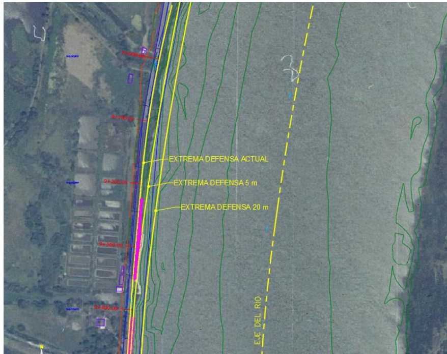
Imagen II. 1 Trazo de eje del río y propuesta de líneas de extrema defensa para la propuesta de alternativas.
