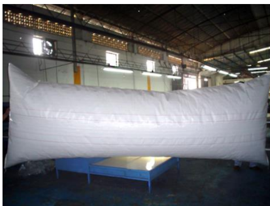
Imagen II. 40 cimbras geotextiles para contener mortero.
