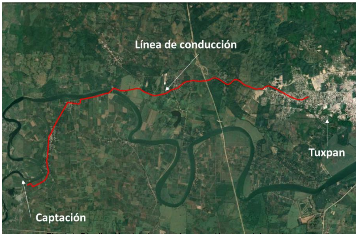
Fig. 2.1. Distribución del sistema de captación y suministro de agua.
