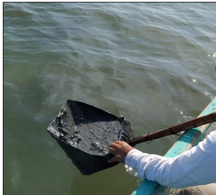
Figura II-22. Vista de la recuperación de muestra de sedimento del fondo de la laguna para su posterior traslado y clasificación en laboratorio.
