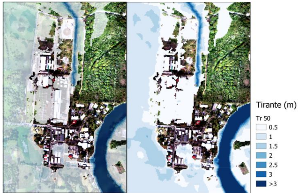
Figura IV.2.1–11 Niveles de inundación en la Zona de Influencia Directa asociada a un periodo de retorno de 50 años.
