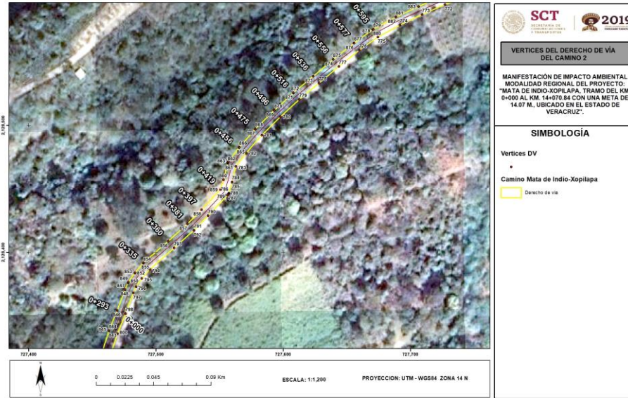
Ilustración 2-3. Ubicación de puntos de inflexión de la poligonal del proyecto por cadenamiento 2
