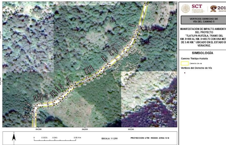
Ilustración 2-6. Ubicación de puntos de inflexión de la poligonal del proyecto por cadenamiento 5
