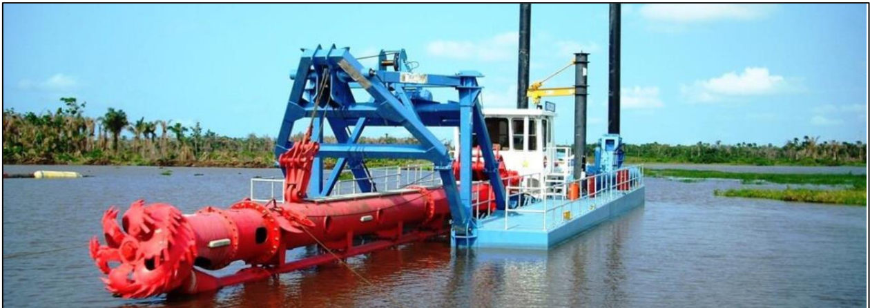
Figura 9. Draga de corte y succión marca Swamp Fox
