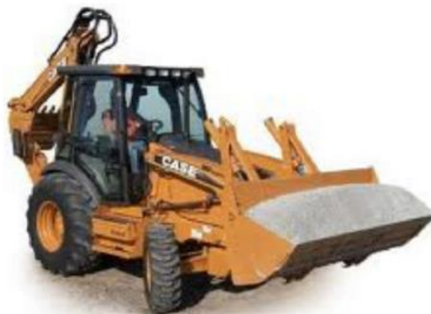
Imagen 2.6 Retroexcavadora a utilizar en el proyecto.
