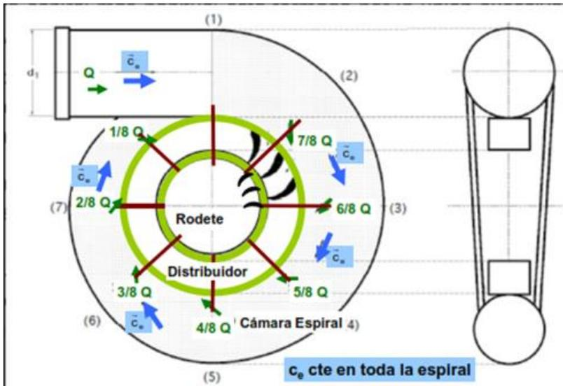
Figura 21.- Cámara espiral de la turbina
