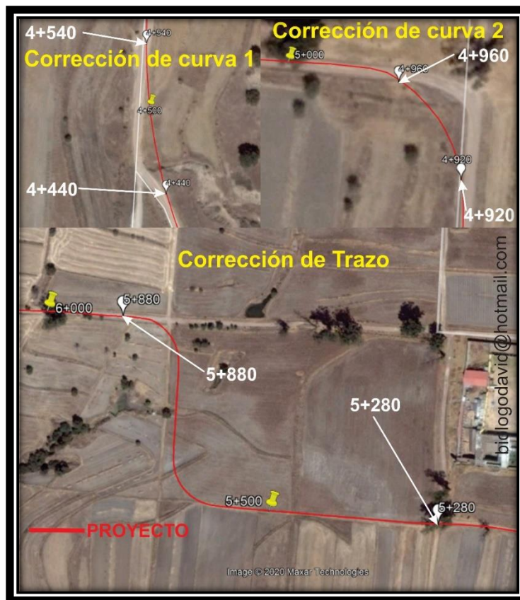
Figura II.3 Vista de las condiciones ambientales actuales en donde se pretende la corrección de dos curvas y la corrección de trazo, con respecto a la terracería existente
