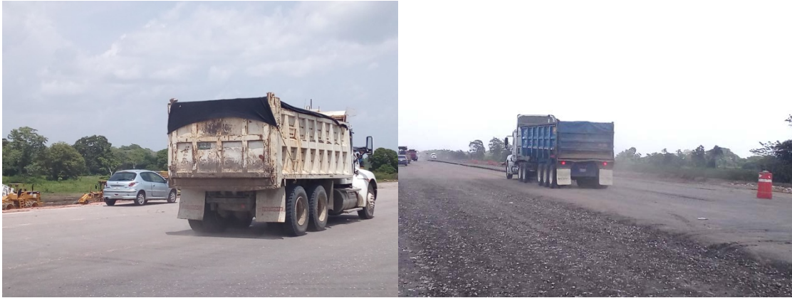
Imagen 2. Camiones de volteo transitando con sus respectivas lonas que cubren el material a transportar.
