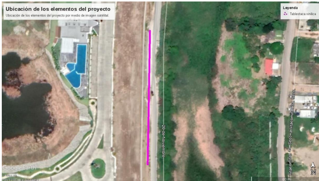
Ilustración 4. Ubicación del sitio en el cual se instalará la tablestaca vinílica que forma parte del proyecto, en la margen izquierda del Río Viejo Mezcalapa, a la altura de la localidad Plutarco Elías Calles.
