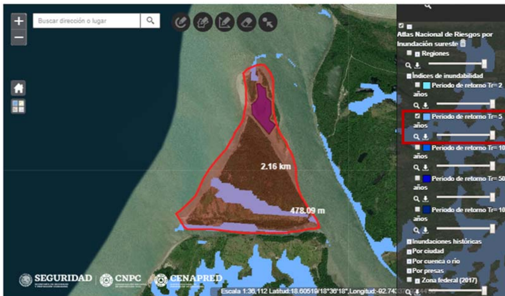
Ilustración 34. Análisis del SA del proyecto y del sitio de depósito que comprende el mismo por medio de los datos de retorno de 5 años de inundaciones, en el cual se puede observar que no se presentan afectaciones a superficies mayores en el SA.
