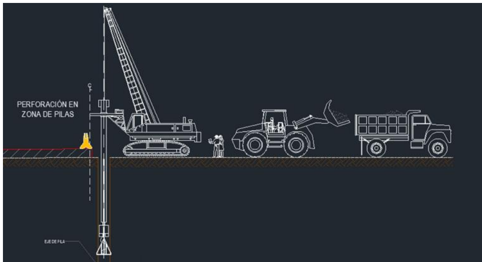
Figura 72. Proceso de perforación para colocación de pilas
