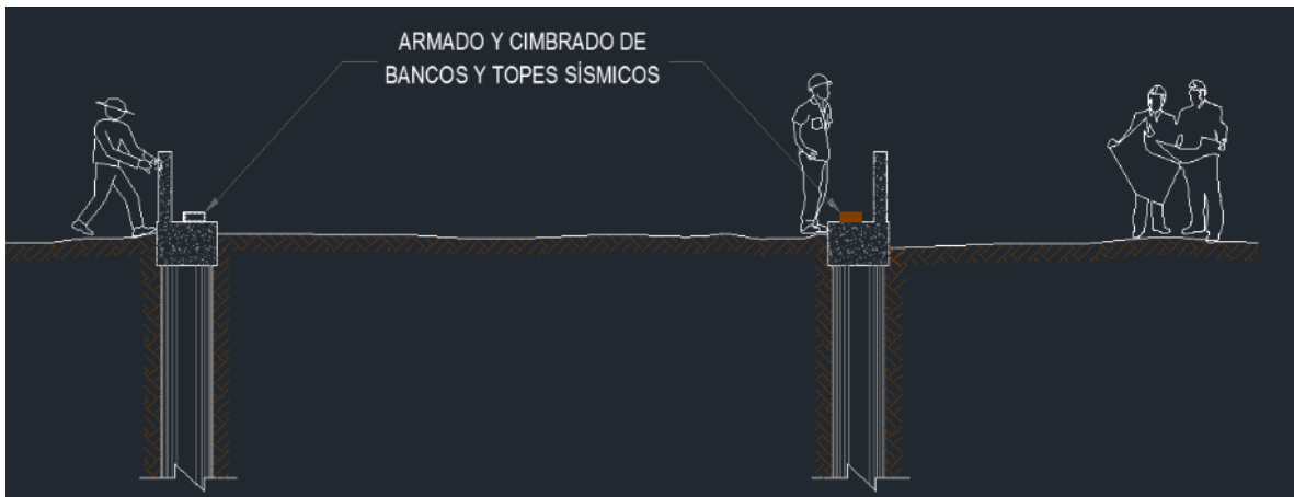
Figura 75. Armado y cimbra de bancos y topes sísmicos
