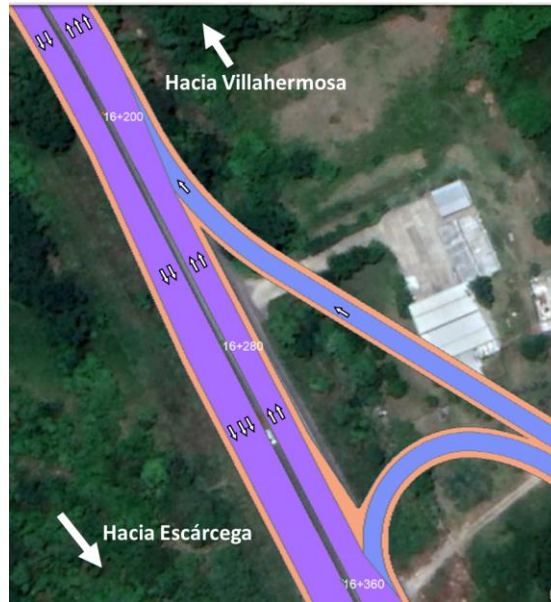
Figura 9. Carriles del Eje 16 comprendidos entre los km 16+209 y 16+367
