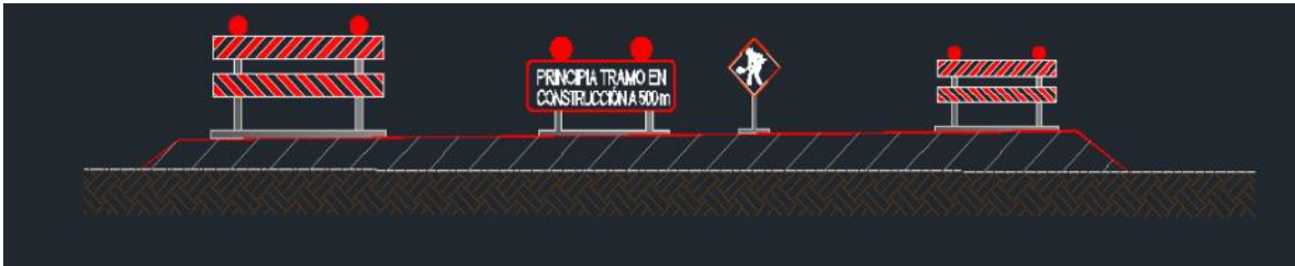
Figura 71. Señalamiento de protección de obra
