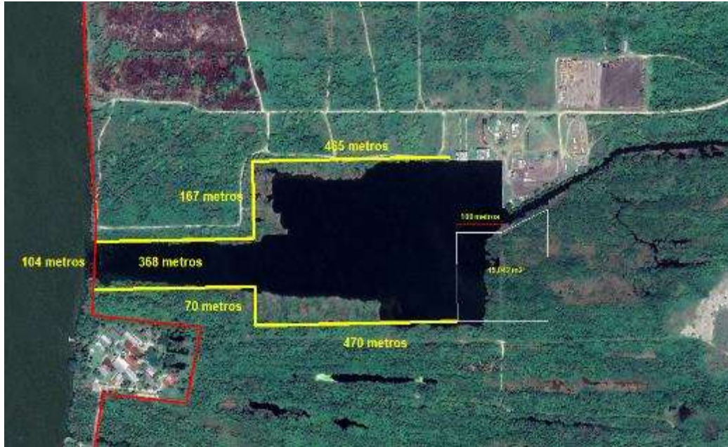
Fig.63. Dimensiones que presentara el canal de acceso fluvial y la dársena.
