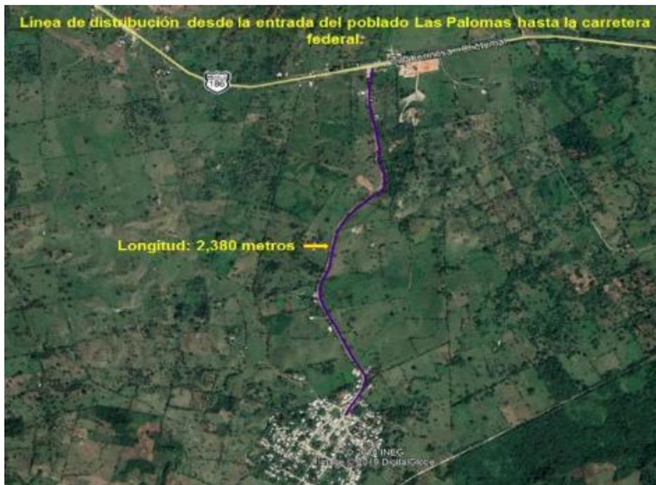
Fig.11.Longitud de la línea de interconexión 2,380 metros.
