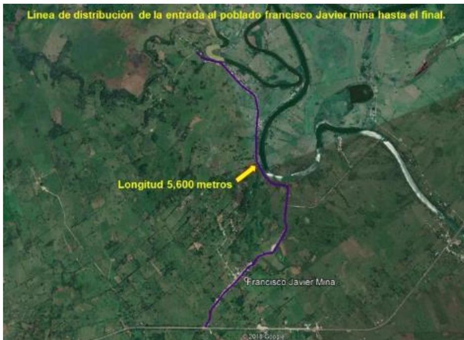
Fig.15.Línea de Interconexión desde la entrada a francisco Javier mina hasta el final.
