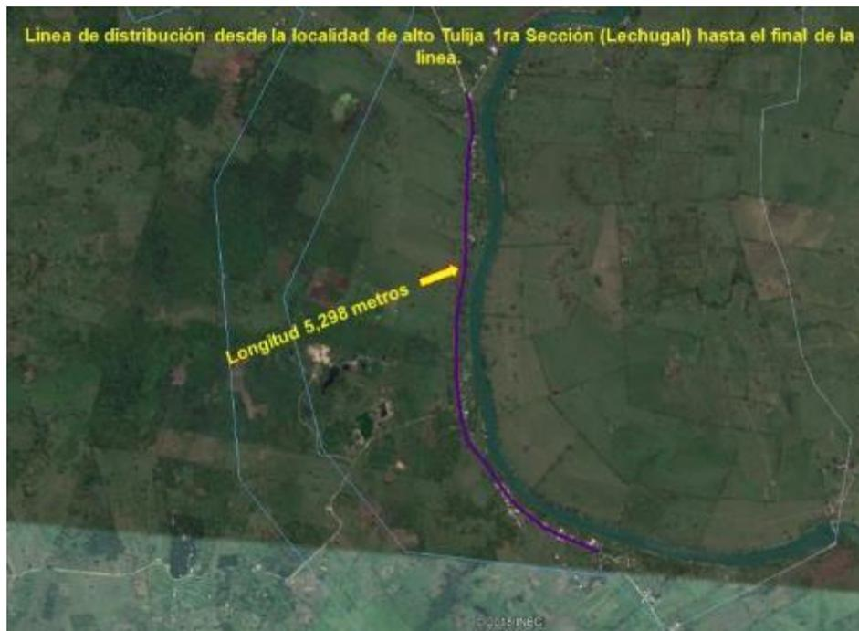
Fig.31. Longitud de la línea de distribución.
