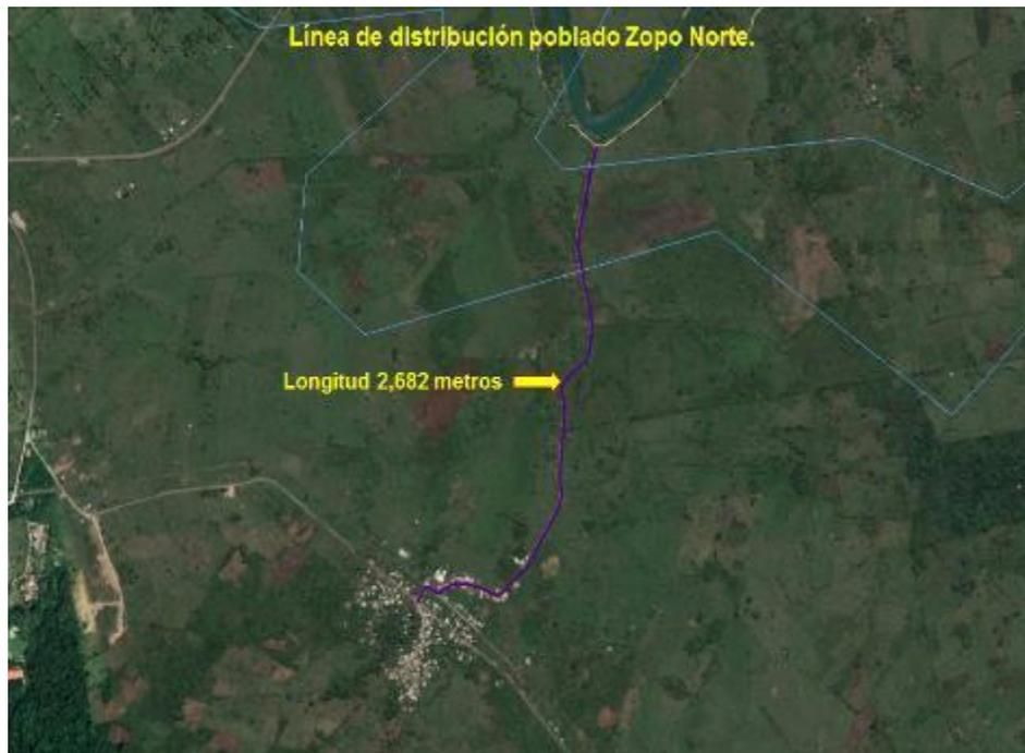
Fig.37. Longitud de la línea de distribución en el poblado Zopo Norte.
