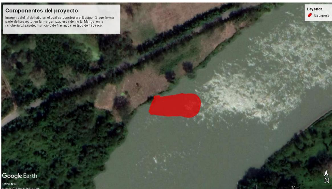
**Ilustración 4.** Proyección en imagen satelital del Espigón 2, que se pretende construir como parte del proyecto.
