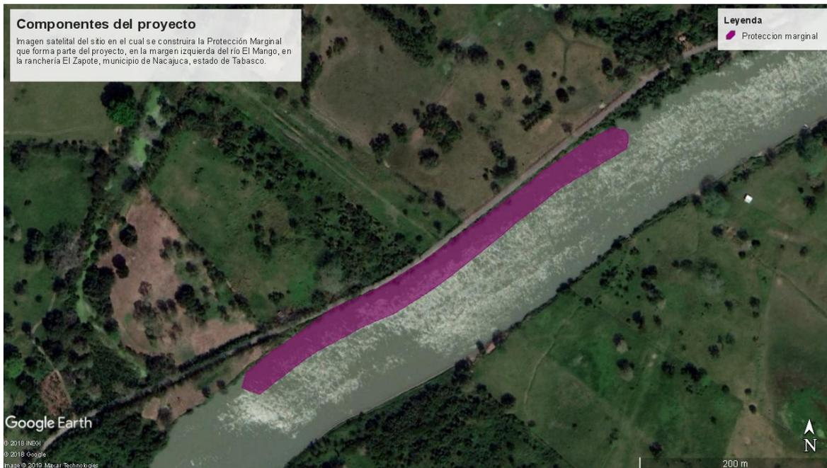
**Ilustración 5.** Proyección en imagen satelital de la Protección Marginal, que se pretende construir como parte del proyecto.
