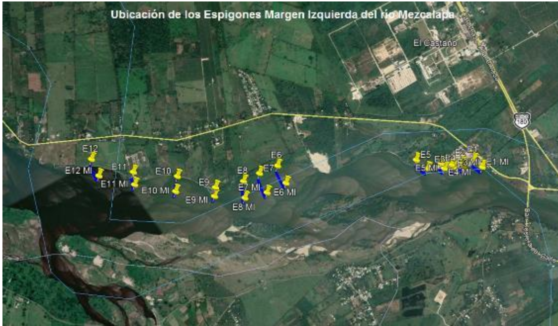
Fig.14. Espigones margen izquierda.
