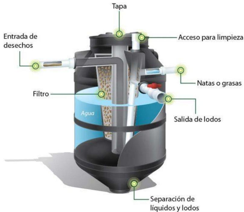
El agua sube y pasa por el filtro anaerobio, reteniendo otra parte de la contaminación, al separar sólidos y líquidos, los líquidos salen mediante un tubo conducido directo al pozo de absorción o zanja de infiltración en el suelo y/o puede utilizarse para riego en patio, esto último, verificando que el agua tratada cumpla con los límites máximos permisibles de contaminantes de los parámetros de calidad de agua de la NOM-003-SEMARNAT-1997, teniendo así un uso sustentable del agua.
