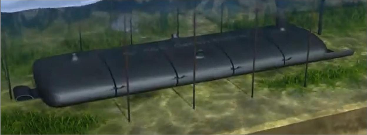
Figura 6. Representación gráfica del proceso de llenado del tubo geotextil y su alineación mediante las cuerdas que lo fijan y posicionan correctamente.
