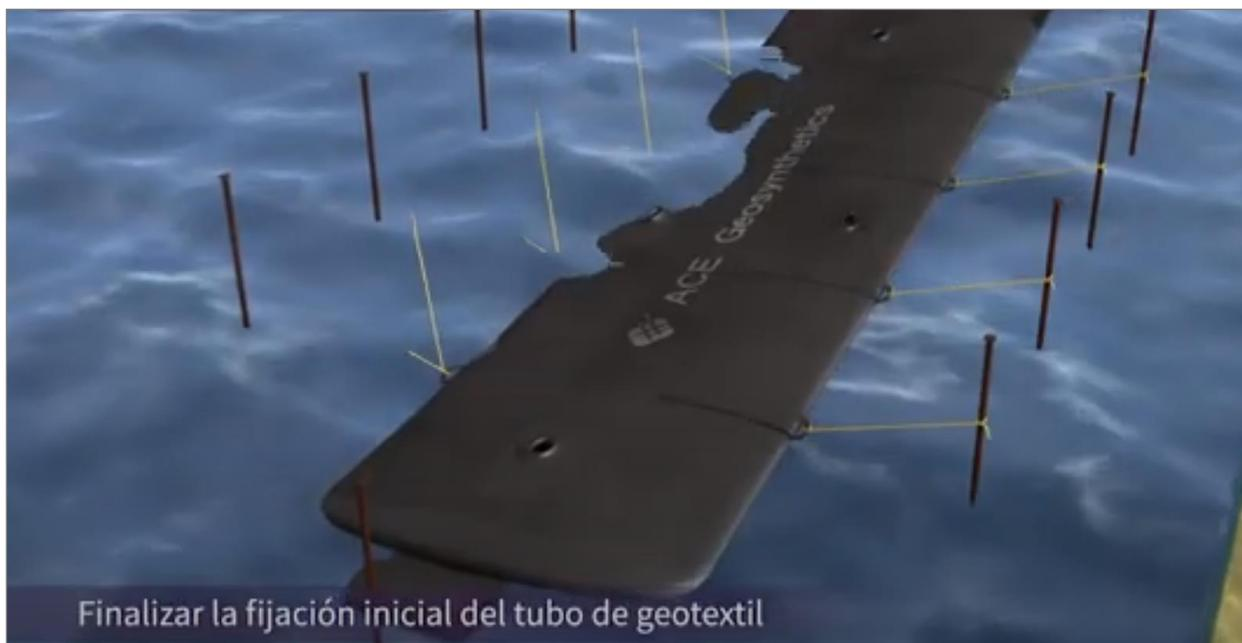
Figura 5. Ilustración de la fijación inicial del tubo geotextil a los rieles de alineación para la conformación de un sistema de protección costera.
