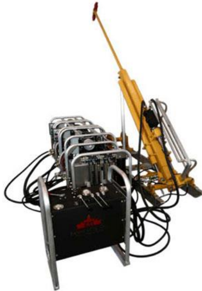
Fotografía 1. Perforadora tipo EGD III.
