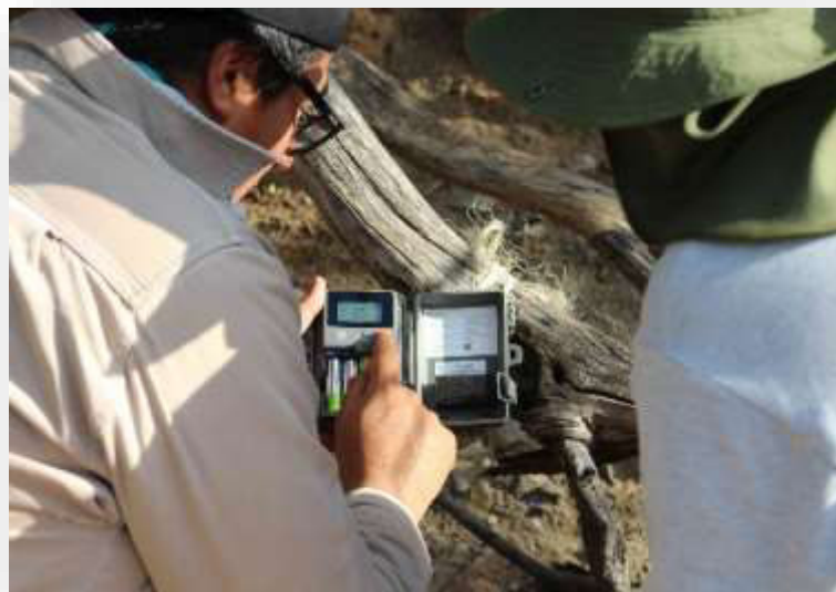
Foto IV-18 Colocación de una cámara-trampa.
