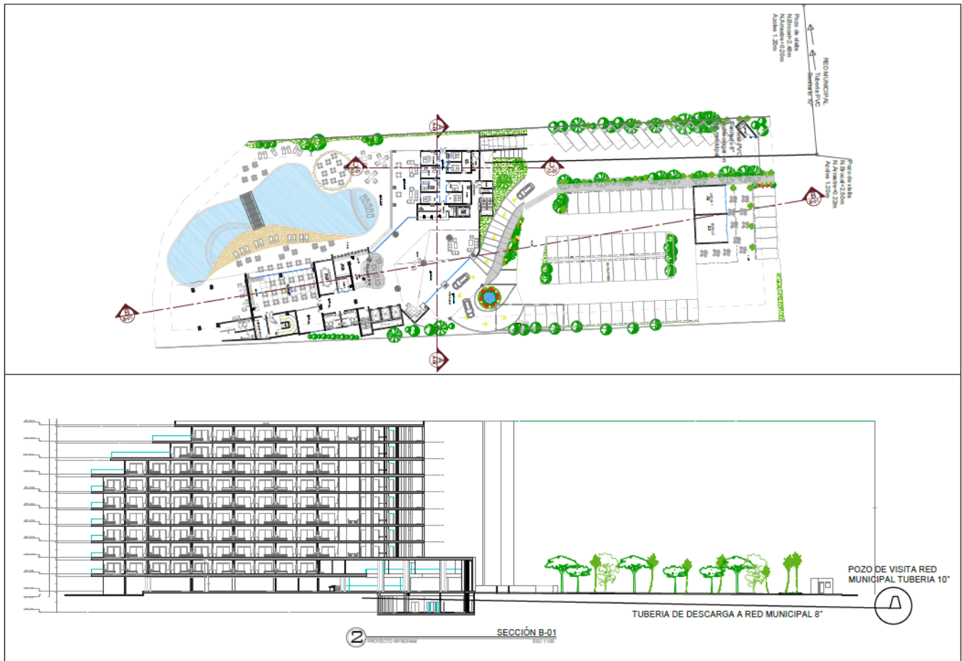
Figura 13. Plano descriptivo línea de conducción de descarga aguas residuales por diferencia de niveles a descargar a red municipal.
