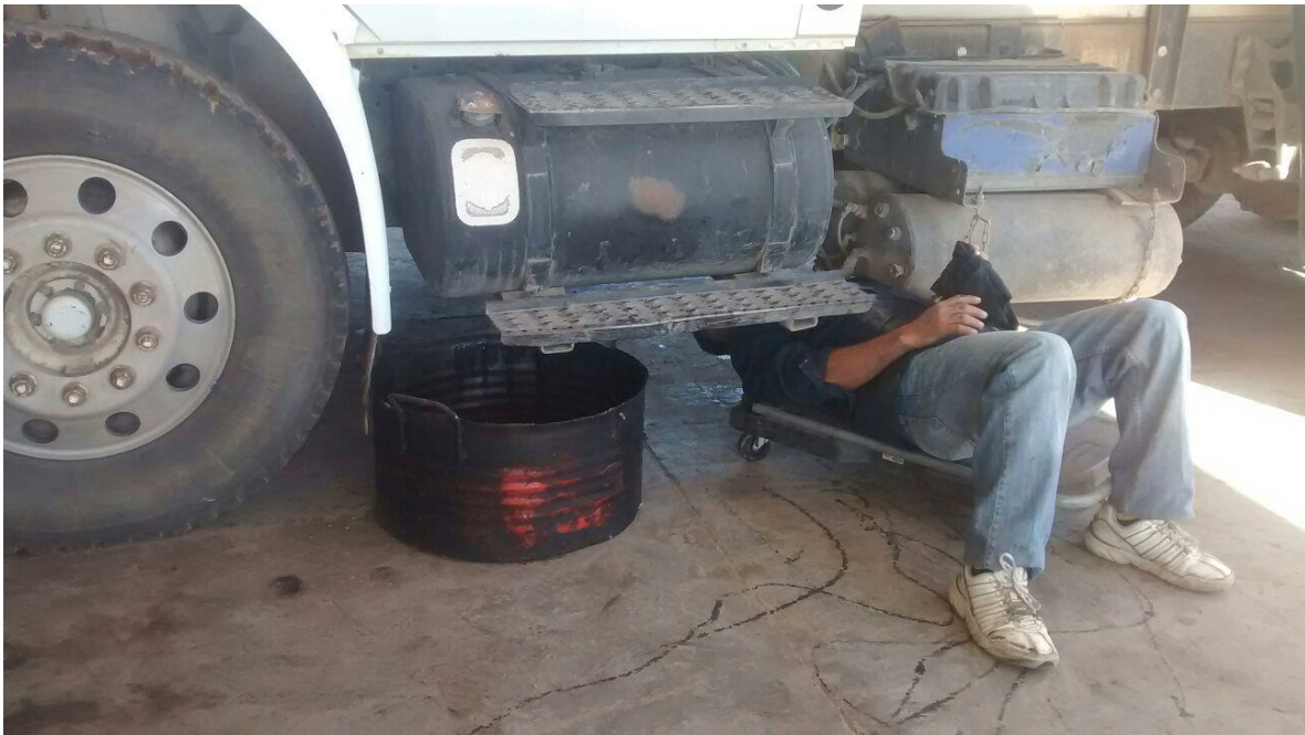
Imagen 20. Charola metálica para evitar derrames.
