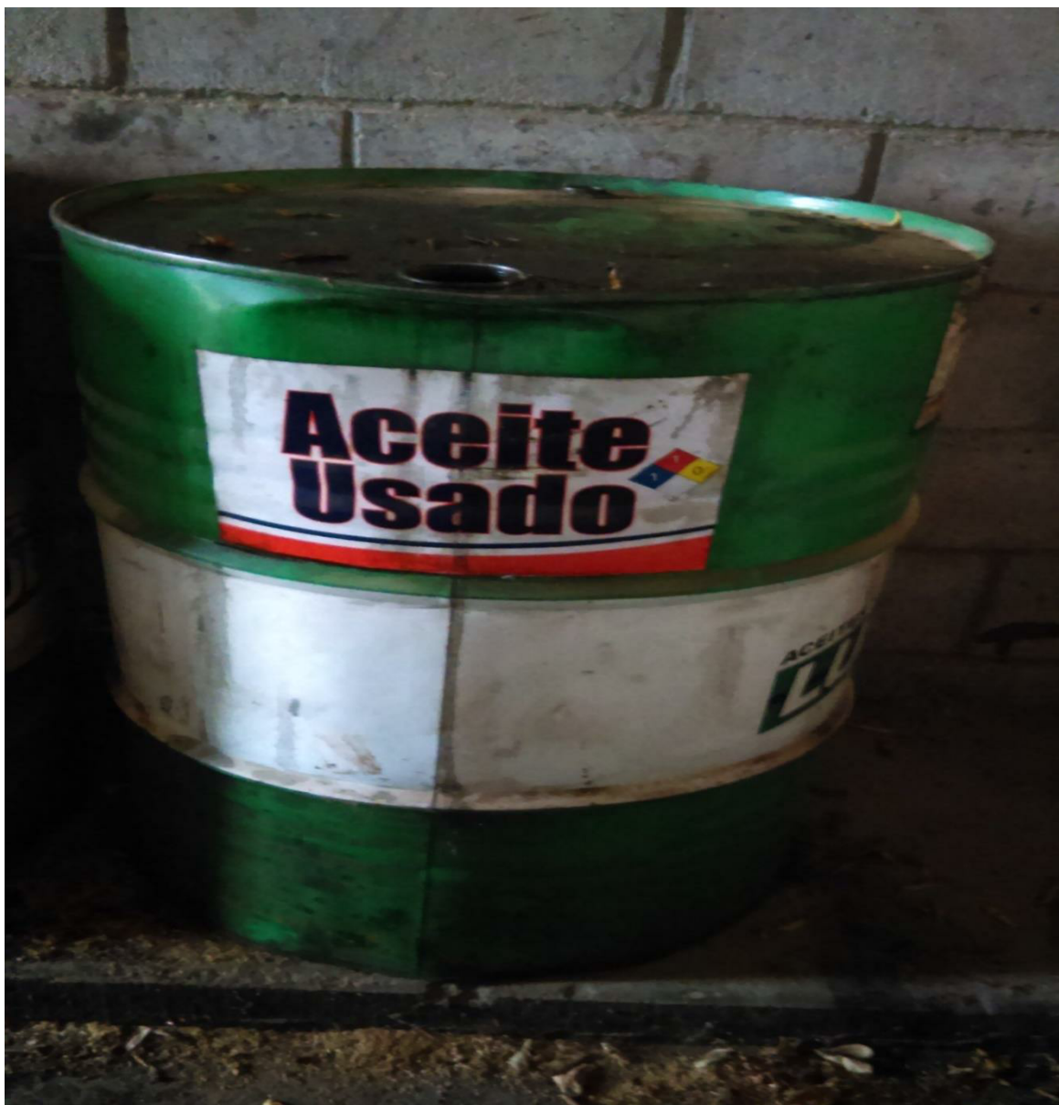
Imagen 21. Tambo de 200 litros rotulado con nombre y código CRETIB del residuo peligroso.
