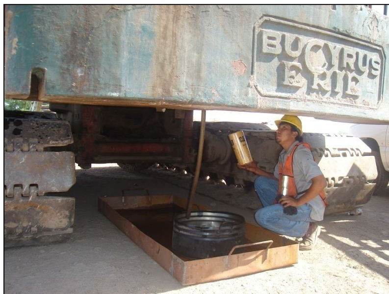
Imagen No. 36.- Charolas utilizadas para derrames accidentales.
