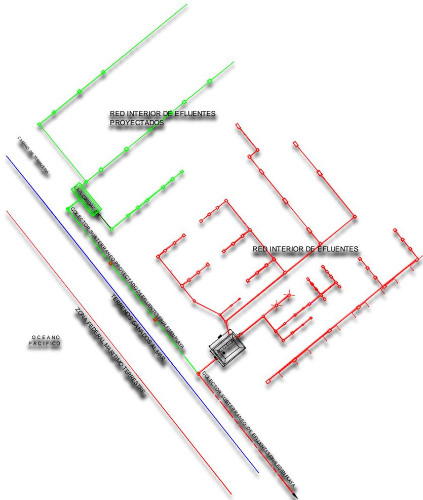
En los módulos de larvicultura y raceways la descarga de las piscinas hacia los registros es por tubería de PVC de 2" y la tubería de los registros hacia la red exterior interconectada con otros registros es con tubería de 4" hasta llegar a la laguna de oxidación.
