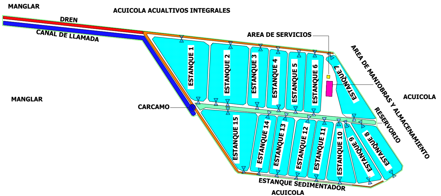
Imagen que muestra la infraestructura de la unidad de producción acuícola de camarón "Acuicola 50". Presenta la distribución de sus estanques de cultivo, canal de llamada, drenes colectores, área de servicio, estanque sedimentador y sus colindantes.
