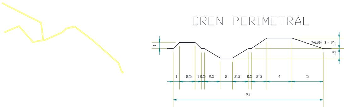
Ilustración 11.- Dren de descarga 1
