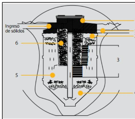
Ilustración 31.- Mecanismo Biodigestor
