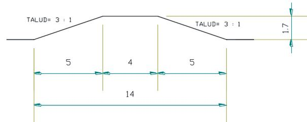
**Ilustración 27.- Construcción de estanquería**
