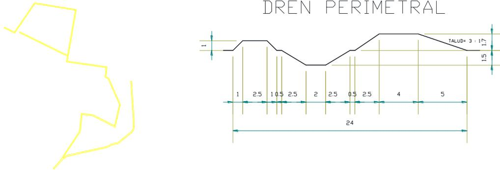
**Ilustración 12.- Dren de descarga 2**
